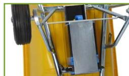
Chassis renforcé avec protection de batterie
